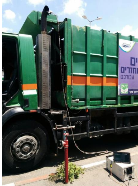
מידת פליטת חלקיקים ממערכת הפליטה של משאית אשפה עירונית (ע"י הטכניון)
